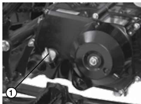
Рис. 12 Щуп контроля уровня масла в двигателе
