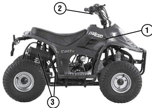
Рис. 3 Вид справа 1. замок зажигания 2. рычаг управления дросселем 3. выхлопная труба с глушителем
