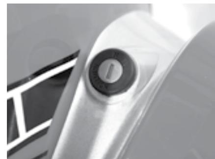
Рис. 5. Замок зажигания
